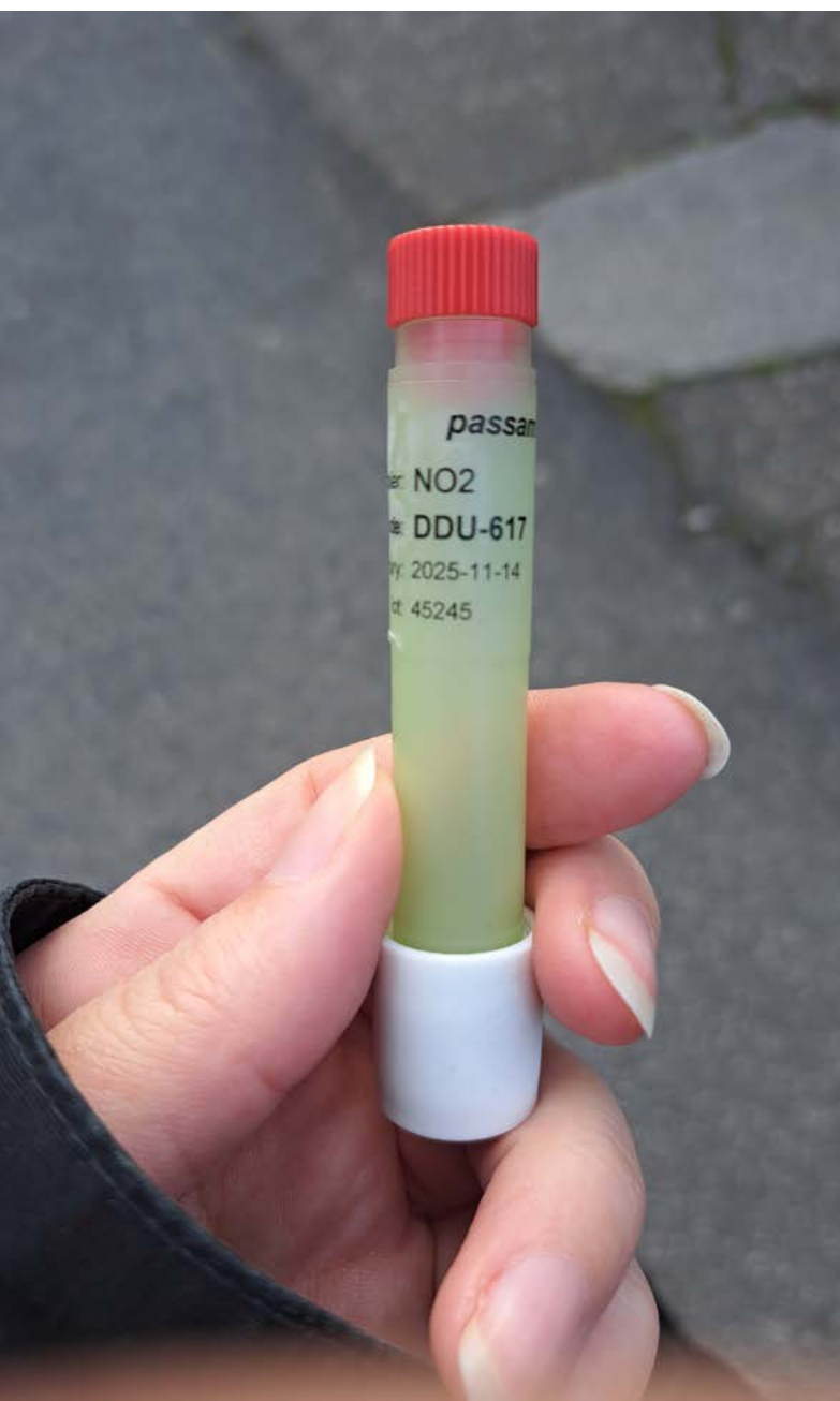
Obr. 2: Difúzne pasívne vzorkovače a príklady ich umiestnenia
