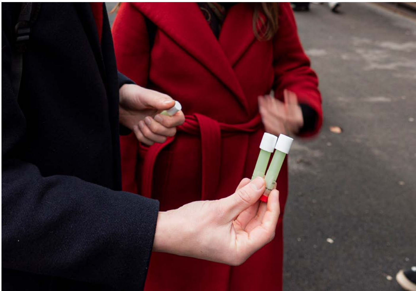
Obr. 11: Pasívny vzorkovač na meranie koncentrácie NO 2
